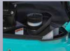
取り外して丸洗いでできる樹脂製燃料タンク。
