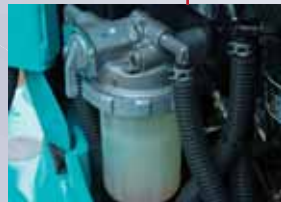
ボンネット内の最前面に設置した ウォーターセパレーター。
