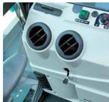
新型キャブではエアコンを標準設定。夏の猛暑日も真冬日も快適に作業可能。エアコンユニットは足元右配置で後方視界もワイドです。また、オプションでヒータを設定しています。
