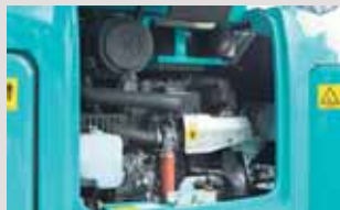
エンジンボンネット：エアクリーナ/ラジエータサブタンク/他
