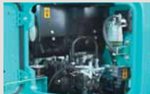
右後方ガード：油圧ポンプ/エンジンオイルフィルタ/ウォータセパレータ/一体燃料プレフィルタ/他
