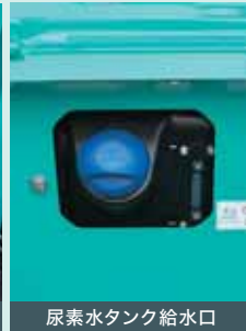
尿素水タンク給水口
