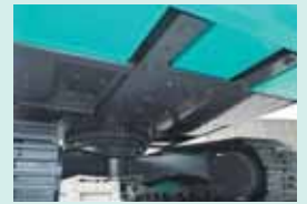
上部本体アンダカバー(強化型、t6mm) ※写真はSK260D-10になります。
