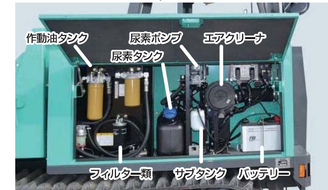
メンテナンスが多い部品を右側に集約しています。
