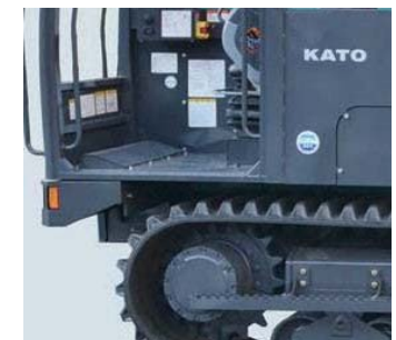
段差を無くして清掃しやすい構造
