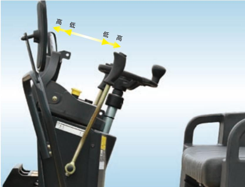
転圧時は、レバー操作に対するスピードの変化を小さくし、微妙なスピード調整を可能としています。
