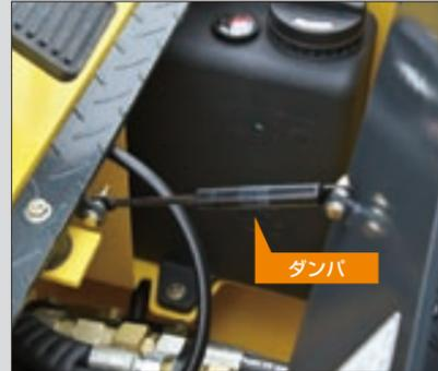
運転席のステップ部分には防振ゴムを装着し、オペレータに不快な振動を与えません。さらに、開口部にはダンパが装着され、容易に開閉可能です。
