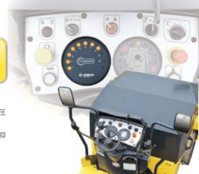
■ 締固め度を簡単に把握！ 機械に搭載した加速度計により、転圧レベルをLEDランプによって10段階でリアルタイムに表示。
