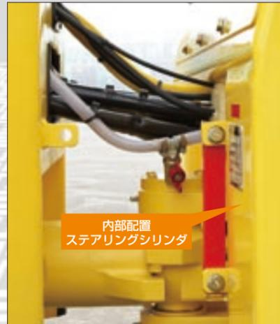
ステアリングシリンダはマシンフレーム内部に配置されており、小石や粉塵によるトラブルを防止します。
