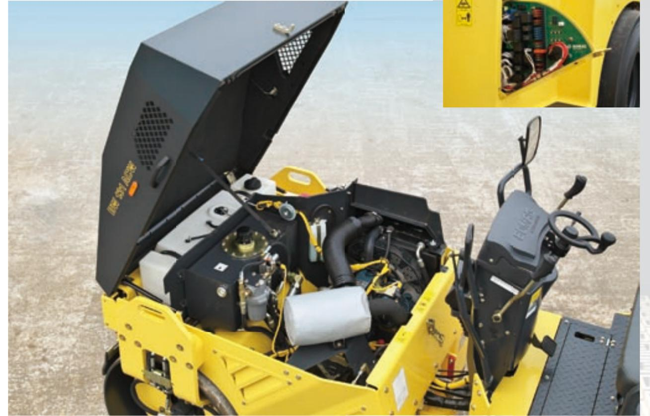
フルオープン式のスチール製ボンネットでメンテナンス性に優れ、破損時にも板金可能です。又、ダンパを装備していますので、開閉操作もラクに行えます。
