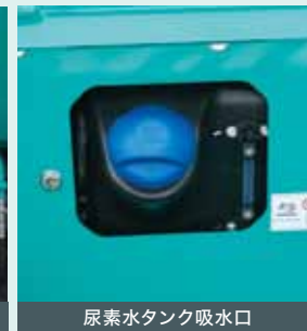
尿素水タンク吸水口
